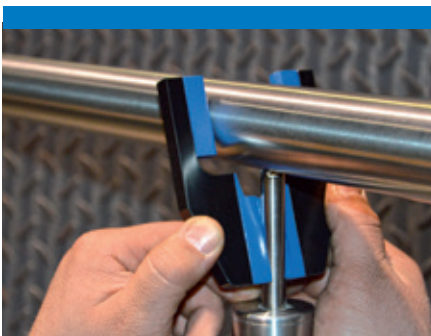
„Abklappen“ der Vorrichtung vom Trägerpin. Détachez le gabarit du poteau.
