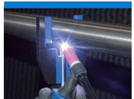
Setzen der Schweißpunkte. Fixez la main courante avec quelques points de soudure au TIG sur votre poteau.
