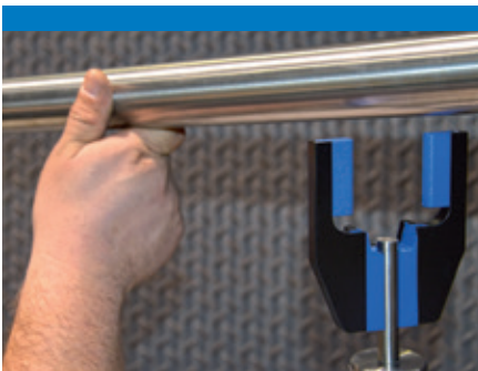
Handlauf in die Vorrichtung einsetzen. Placez la main courante dans le gabarit.
