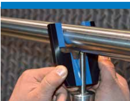
„Abklappen“ der Vorrichtung vom Trägerpin. Retirer le gabarit du montant.
